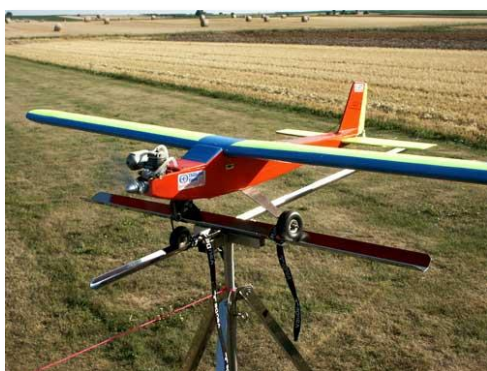
Beispiel, wie ein Flugmodell auf einer Haltevorrichtung befestigt werden kann
