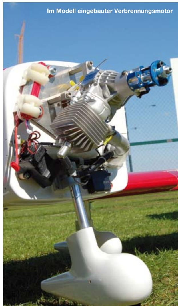
Im Modell eingebauter Verbrennungsmotor
