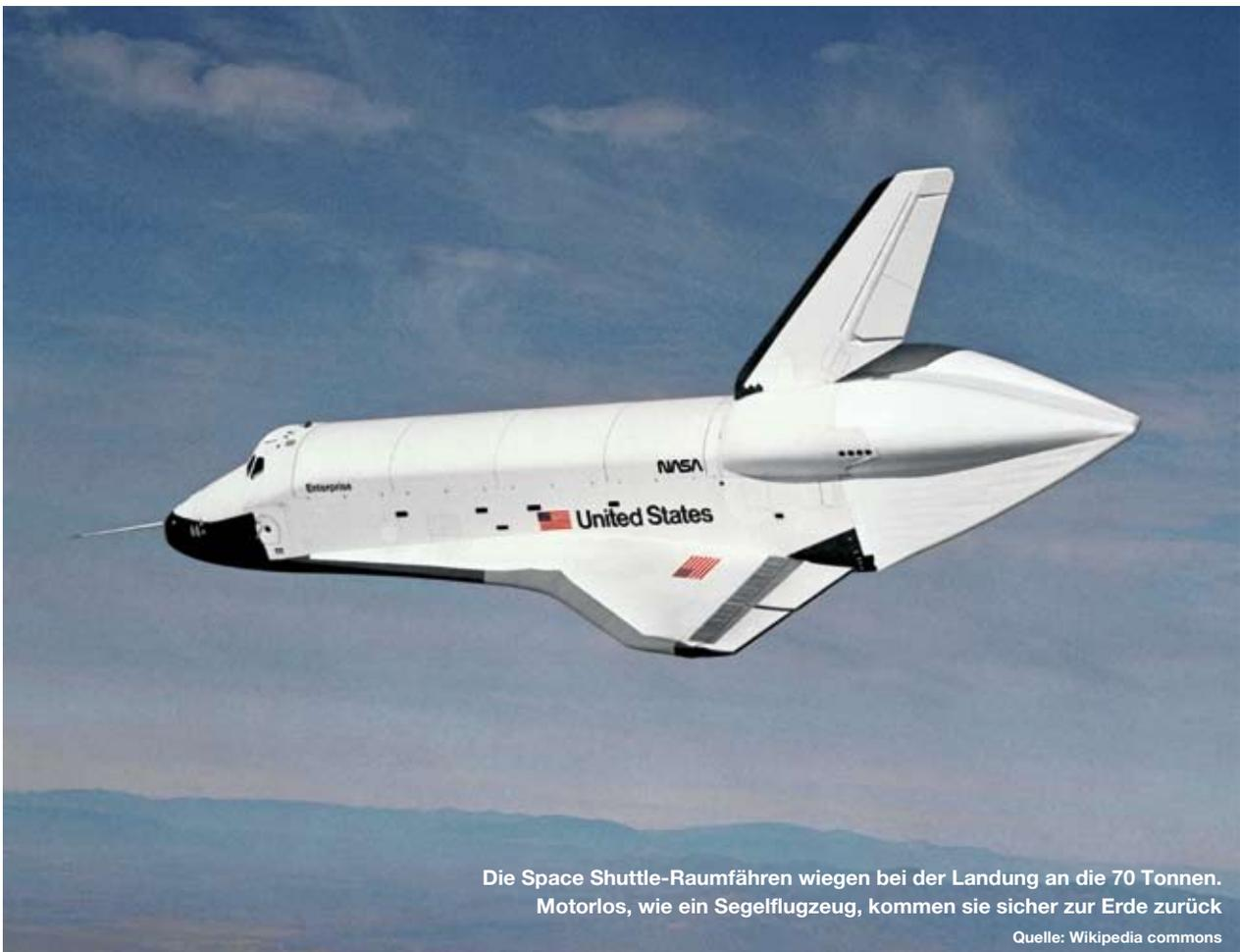
Die Space Shuttle-Raumfähren wiegen bei der Landung an die 70 Tonnen. Motorlos, wie ein Segelflugzeug, kommen sie sicher zur Erde zurück
