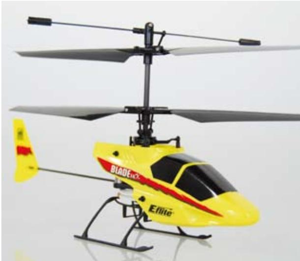
**Hubschrauber sind schwer zu fliegen. Nicht aber so genannte Koaxial-Helis mit zwei gegensätzlich drehenden Rotoren**
